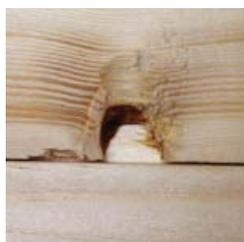
Der bei uns eingesetzte Rauspund verfügt immer über eine gute dicke und eine schlechtere dünne Seite. Eine hohe Astanzahl der Bretter unterstreicht die Natürlichkeit des Holzes und ist keine Qualitätsminderung. Diese Bretter können zusätzlich auf der Unterseite Baumkanten oder teilweise eine fehlende Nut oder Feder haben.
